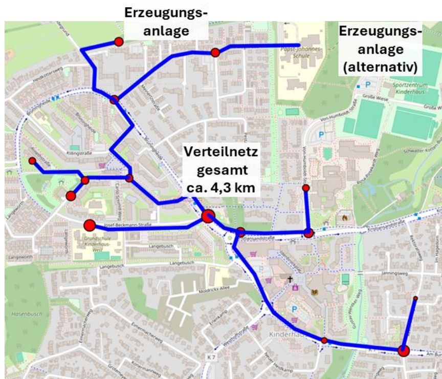
Abbildung 97: Entwurf für ein Verteilnetz im Fokusgebiet Kinderhaus
