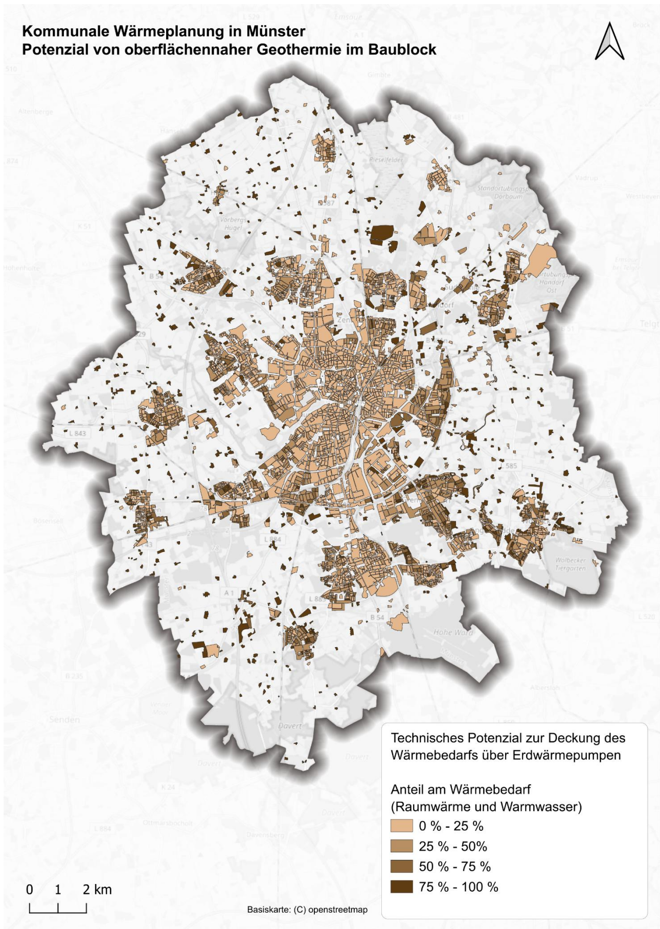
Abbildung 50: Technisches Potenzial von oberflächennaher Geothermie, Darstellung auf Baublockebene
