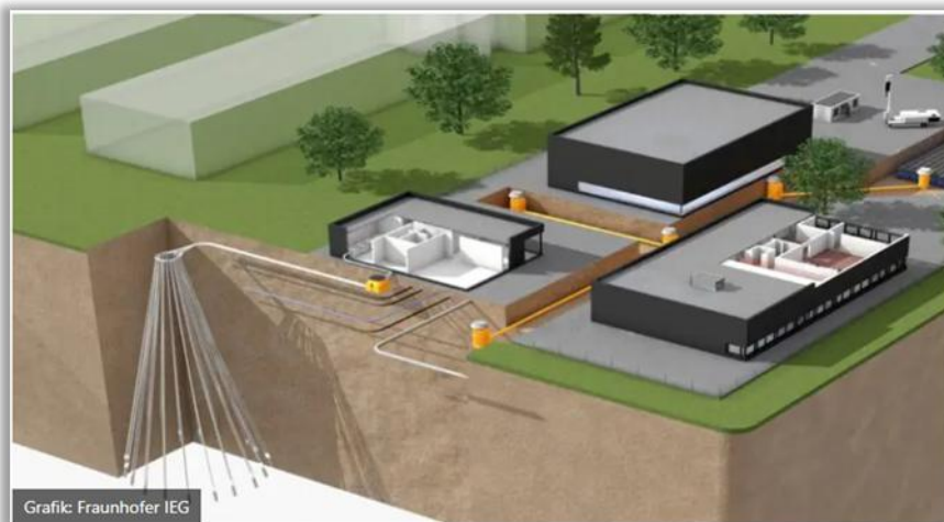
Abbildung 111: Prinzipdarstellung Geostar-Erdsonden (Fraunhofer IEG)
