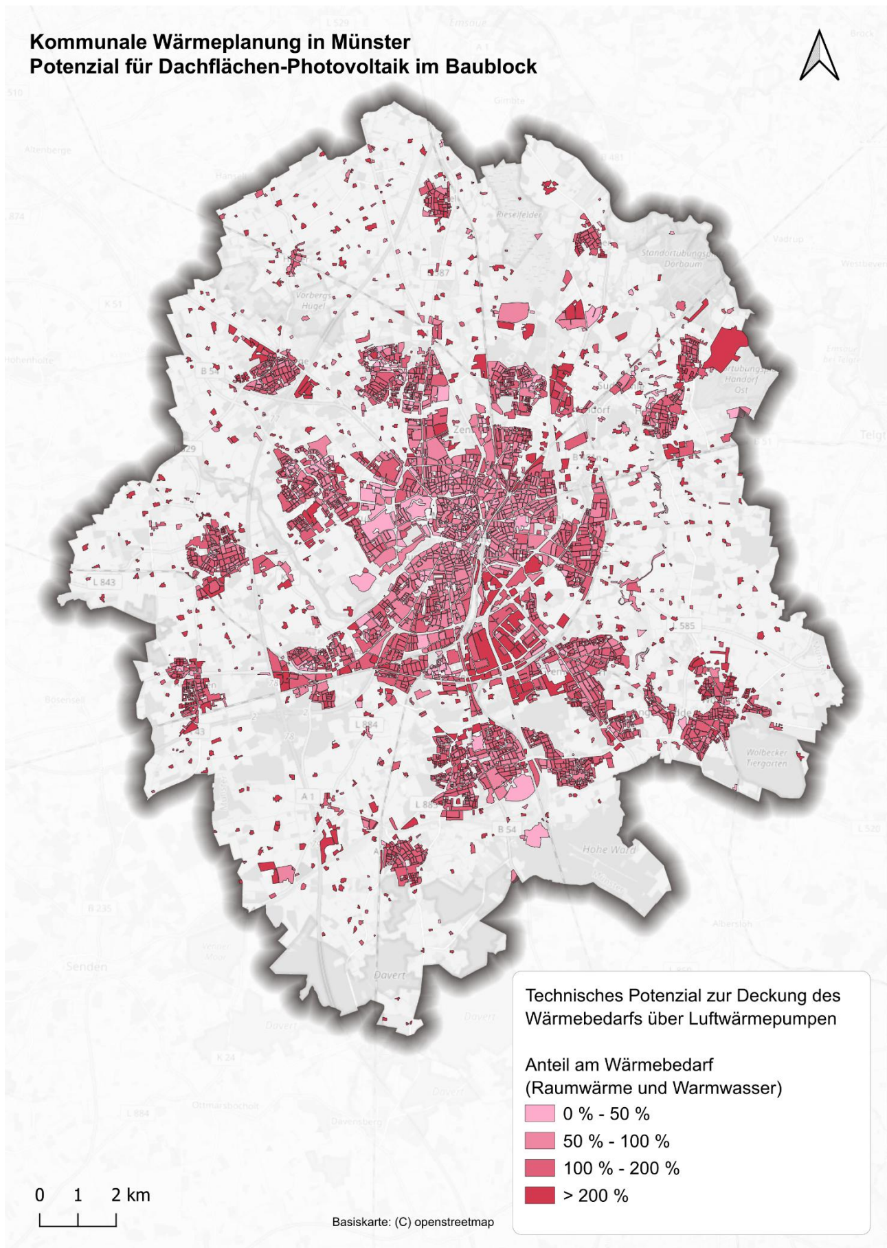
Abbildung 64: Technisches Potenzial von Dachflächen-PV, Darstellung auf Baublockebene
