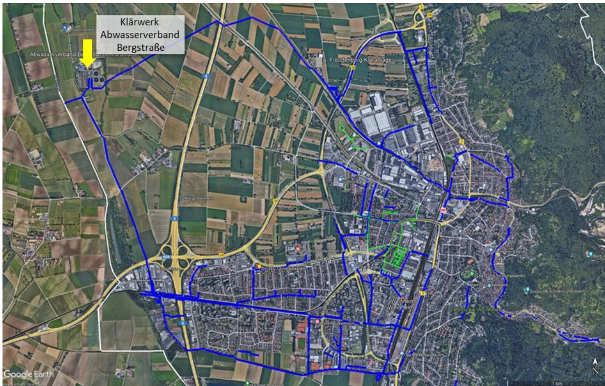
Abbildung 67: Lage Kläranlage (gelber Pfeil) und Entwässerungsnetze in Weinheim, Quelle: Stadt Weinheim (1), Google Earth (15), eigene Darstellung
